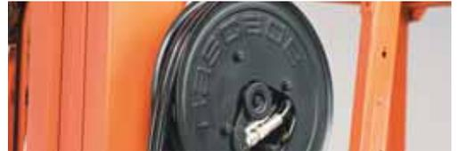
Ofrece un medio sencillo y económico para situar las horquillas en el posicionador de horquillas en serie K. Permite utilizar una sola válvula auxiliar para controlar una función hidráulica adicional. Elimina la necesidad de mangueras hidráulicas o cables eléctricos y permite un tiempo de instalación mínimo.
