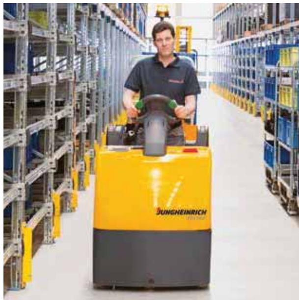
**EZS 010:** mini remolcadora para la cómoda tracción de remolques de hasta 1.000 kg.
