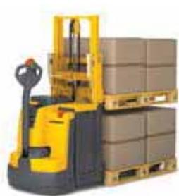
Vehículo con conductor a pie EJD 220, en la versión corta EJD K18, ideal para transporte en camión
