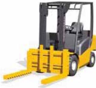
**Pinza para bloques de hormigón**
