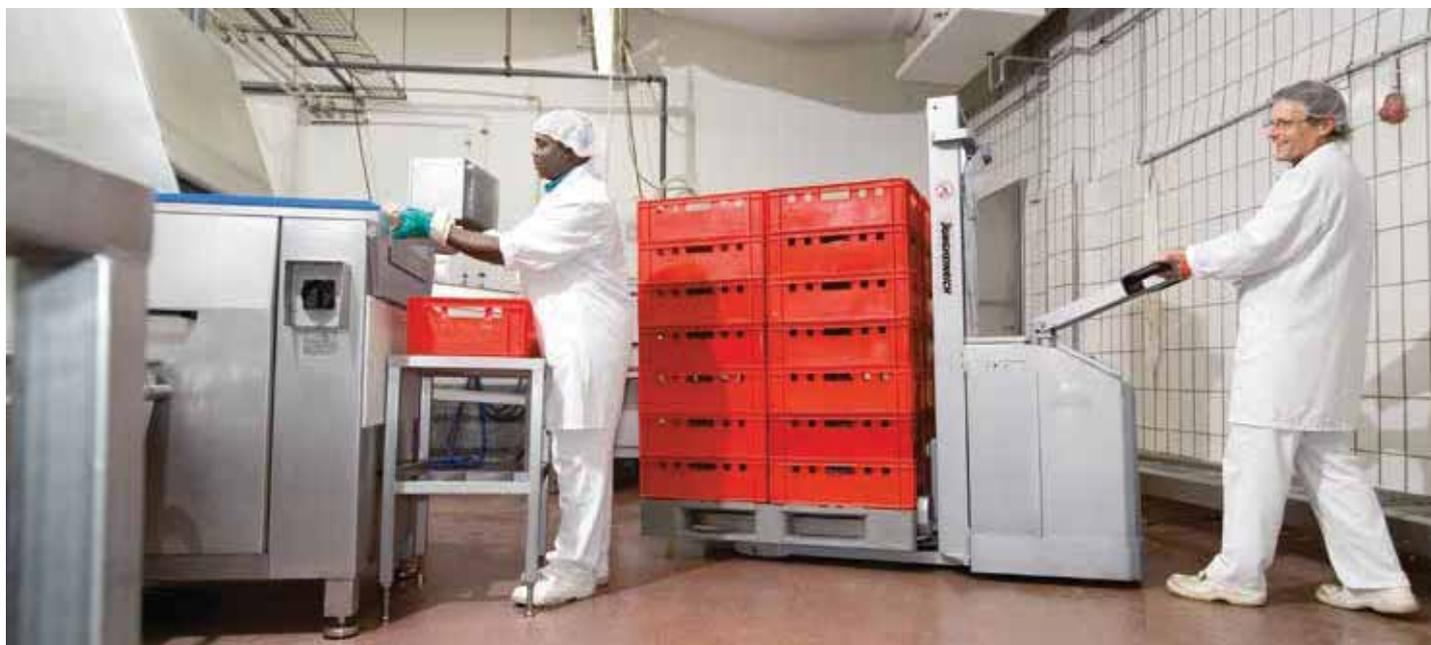
La transpaleta de acero inoxidable EJE i25 (2.500 kg de capacidad de carga) y la apiladora de acero inoxidable EJC i15/i15z (1.500 kg de capacidad de carga) están concebidas para aplicaciones difíciles en entornos húmedos y agresivos. Dos motores independientes consiguen un potente accionamiento y garan-
