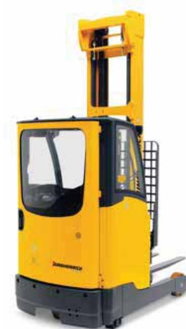
Baja altura de acceso para una fácil entrada y salida del vehículo.
