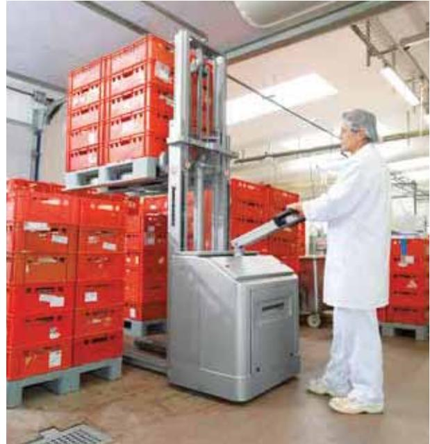
La transpaleta de barra timón EJE i20 (2.000 kg de capacidad de carga) y la apiladora de barra timón EJC i12z (1.200 kg de capacidad de carga) ofrecen las mejores condiciones para el uso en entornos húmedos y corrosivos y cumplen así con las más altas exigencias de higiene. Por eso resultan perfectas para el uso en la industria alimentaria.
