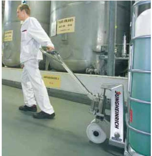
Las transpaletas de acero inoxidable, las apiladoras de barra timón y las transpaletas con barras de apoyo pueden emplearse en cualquier lugar donde se requiere una completa higiene y protección contra explosiones, o donde deba emplearse material inoxidable porque el entorno es húmedo o difícil.
