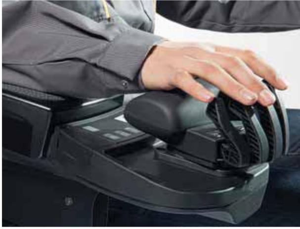
**Puede elegir entre tres sistemas de mando diferentes:** DUO-PILOT, MULTI-PILOT o SOLO-PILOT. Todos ellos tienen algo en común: la asignación ajustable de las palancas/ejes. Esta determina qué función se aplica a qué palanca.
