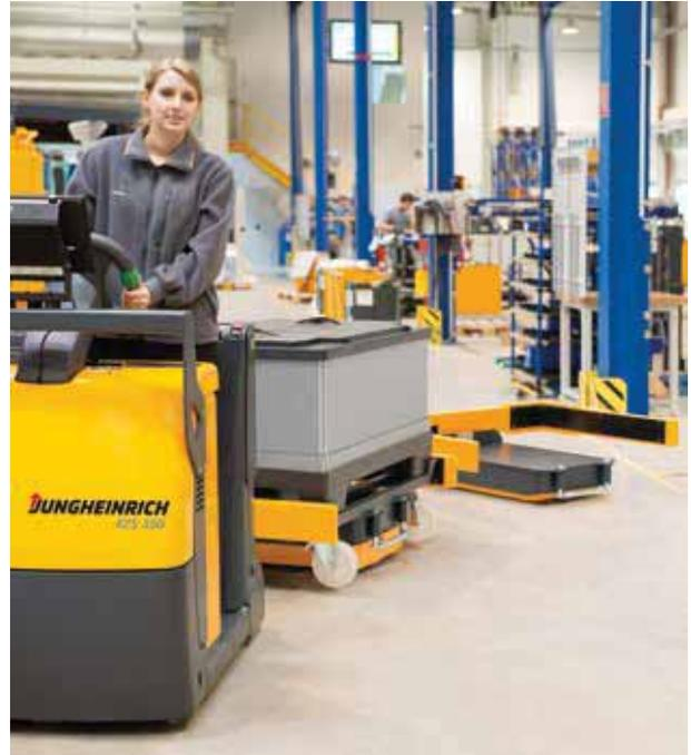
**GTP:** nuestros remolques de pórtico GTP garantizan el transporte flexible y rentable de cargas de hasta 1.000 kg de peso por remolque. Gracias a la posibilidad de cargar los remolques por ambos lados, se pueden recorrer rutas inversas con la misma remolcadora.
