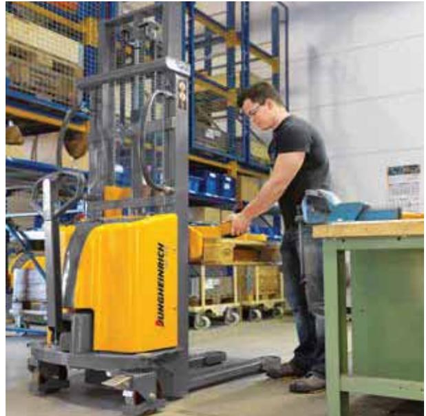
La apiladora electromanual HC 110 es una alternativa económica para procesos esporádicos de apilado (de 1.600 a 3.000 mm de elevación), y para la descarga de camiones. La HC obtiene la energía necesaria de su batería, que no requiere mantenimiento y puede cargarse en cualquier enchufe normal de 230 V. El cargador integrado proporciona una carga cómoda y fiable.
