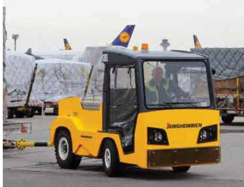
**EZS 6250:** remolcadora para la tracción de cargas de hasta 25.000 kg. Conviene con sus equilibradas propiedades de marcha y una construcción especialmente robusta. Una potente aceleración y altas velocidades finales en trayectos largos se combinan con un manejo preciso cuando el espacio es reducido y se hace necesario disponer de una buena maniobrabilidad.
