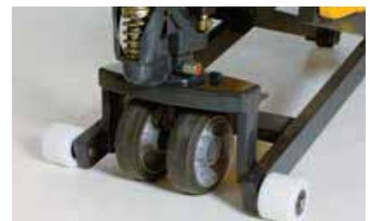
A partir de una altura de horquilla de aprox. 350 mm, las barras de apoyo proporcionan seguridad adicional. Estas pueden sustituirse por rodillos laterales de apoyo opcionales.
