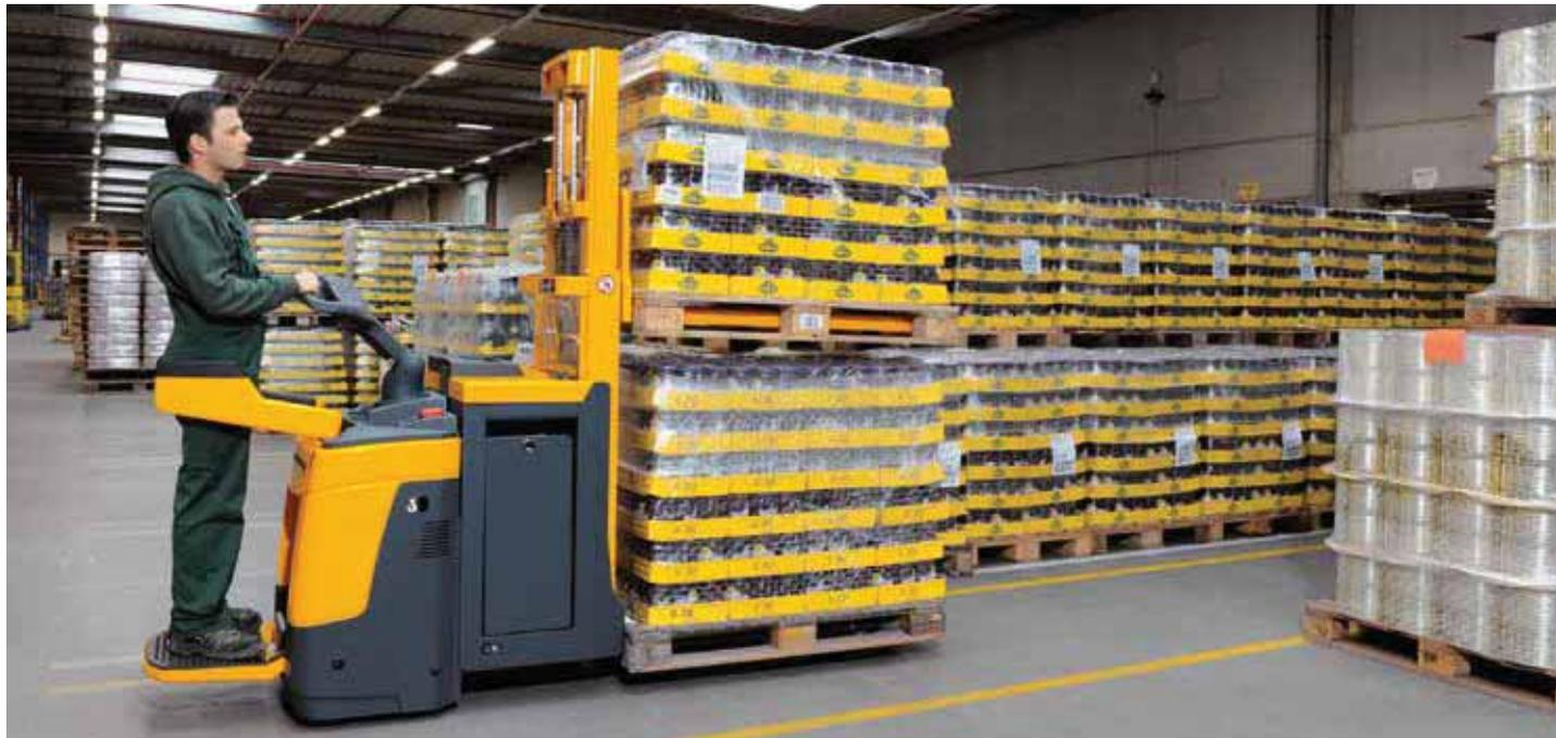
La ERD 220 es una montacarga multidisciplinar. Combina las prestaciones de las transpaletas y las apiladoras en una sola montacarga: desde la carga y descarga de camiones hasta el transporte de palets, pasando por tareas de
